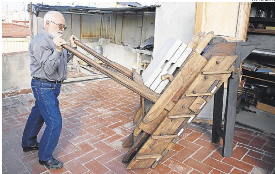
► Herminio aixeca 100 quilos a la seva 'rampa elevadora manual'.
